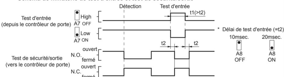
\* Le délai de test d'entrée est la période entre le test d'entrée et le test de sécurité/sortie.
