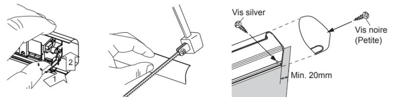
**NOTE** S'assurer de disposer d'un peu d'espace entre les clips de montage et les vis. Veiller à ne pas rayer le profilé pendant le perçage du trou.
