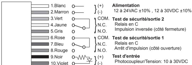
**NOTE** Lorsqu'un test d'entrée n'est pas nécessaire, régler le commutateur DIP A7 sur OFF.
